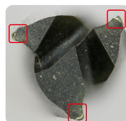
采用钴铬合金加工7米后存在边缘磨损情况
