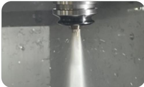
Das im Schaft integrierte patentierte Kühlmittelsystem des CrazyDrill Titanium TK ermöglicht prozesssicheres Bohren mit hohen Vorschüben bei 15bar Kühlmitteldruck. Auch die Standzeit der CrazyDrill Titanium TK setzt gegenüber den Mitbewerbern einen neuen Benchmark. Für Anwendungsfälle ohne die Möglichkeit einer inneren Kühlmittelzuführung hat Mikron Tool den Hochleistungs-Mikrobohrer CrazyDrill Titanium TN entwickelt, der konsequent auf externe Kühlschmierstoffversorgung hin ausgelegt wurde.
