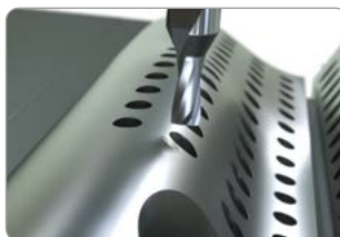
Forature inclinate su superfici convesse fino ad un angolo di ca. 60°.
