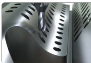
Forature inclinate su superfici concave fino ad un angolo di ca. 60°.
