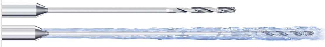
Avec CrazyDrill Flex, Mikron Tool propose un foret en carbure conçu pour le perçage profond jusqu'à 50 x d. Gamme de diamètres de 0,1 à 2,0 mm en deux versions :
