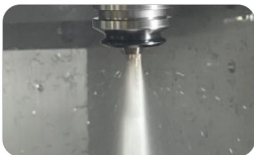
Le système d'arrosage breveté intégré dans la queue du CrazyDrill Titanium TK permet un perçage fiable avec des avances élevées et une pression d'arrosage de 15 bars. La durée de vie de la CrazyDrill Titanium TK établit une nouvelle référence par rapport à ses concurrents. Pour les cas d'application sans possibilité d'arrosage interne, Mikron Tool a mis au point le micro-foret haute performance CrazyDrill Titanium TN.
